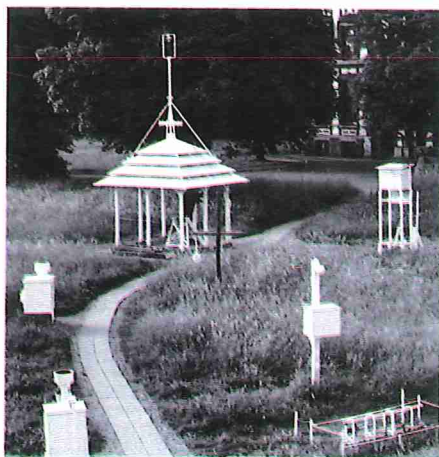
Figuur 1. Foto van de Pagode met in de nok van het dak de thermograaf. De foto is genomen op het moment van aflezen van thermograaf. Het is geen verrassing dat met deze opstelling de temperatuur onder de kap flink op kon lopen – wat wellicht verklaart waarom de hoogste temperatuur ooit gemeten in De Bilt in 1947 valt. Naast de Pagode staat een Stevensonhut. De hoogte van de thermometer in die hut was 2.20 m, vandaar het trapje voor de Stevensonhut. Merk op dat het meetveldje destijds niet bepaald aan de huidige WMO normen voldeed.
